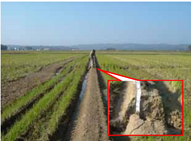
液状化によって水田内にも30cm程度の段差が発生しており、耕作不能な状態となっている。
