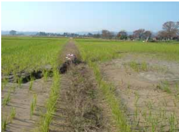
同上。液状化によって水田内に20cm程度の段差が発生している。幅が数cm～数十cmのクラック(地割れ)を伴っている。
