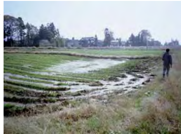
越路町西野(須川左岸側)の水田地帯に生じた噴砂。噴砂は幅数十mの帯状に分布が確認される。
