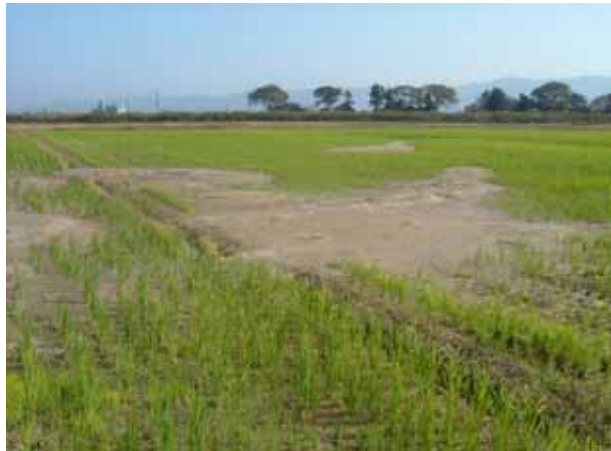
越路町西野(須川左岸側)の水田地帯に生じた噴砂。噴砂は幅数十mの帯状に分布が確認される。
