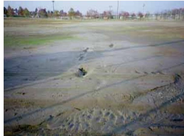
同上。液状化地盤の沈下に伴い、段差やクラックが生じている。
