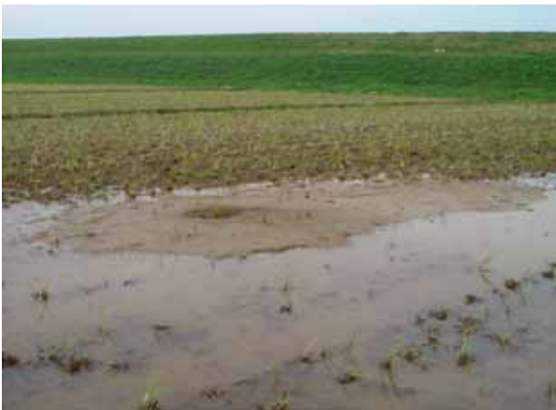
同上。規模の大きな噴砂口の周囲では噴水を伴っている。
