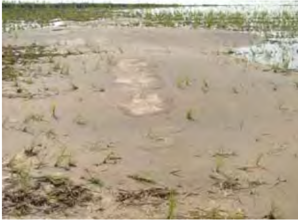
越路町釜ヶ島の水田地帯に見られる噴砂群。広範囲にわたって噴砂・噴水の被害が生じている。
