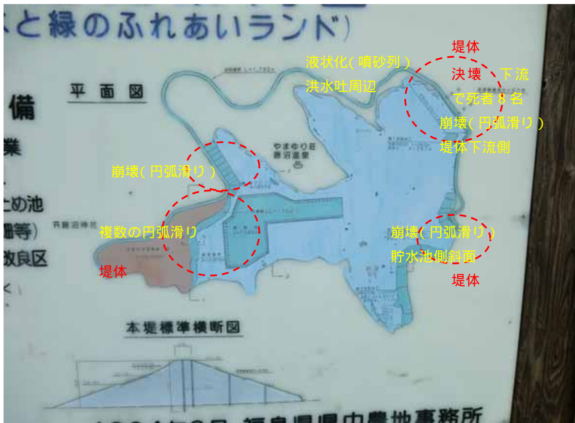
写真-1 藤沼ダムの平面図 ( 決壊した堤体の左岸広場の案内版 )
