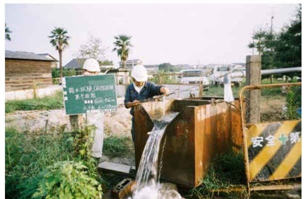
揚水試験状況
