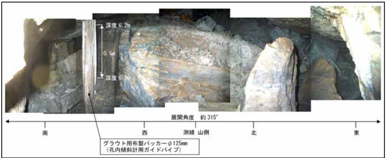
写真-4 空洞展開写真 深度6.2m~6.7m(事例1)
