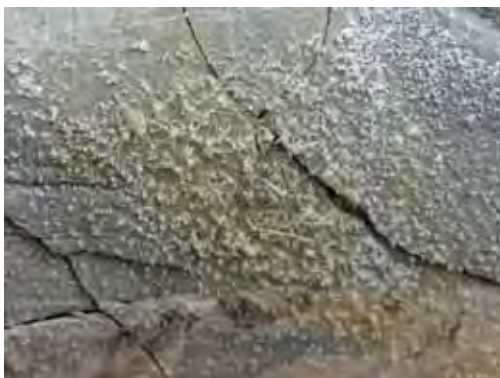
写真-4 泥岩表面に析出した硫酸塩類
