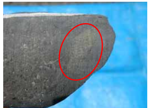
写真-2 泥岩ボーリングコアに見られる黄鉄鉱
