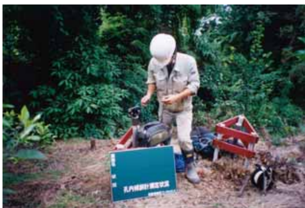
孔内傾斜計観測状況
