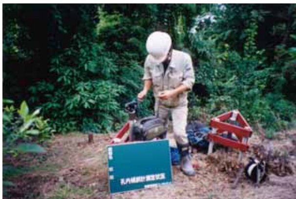
孔内傾斜計観測状況
